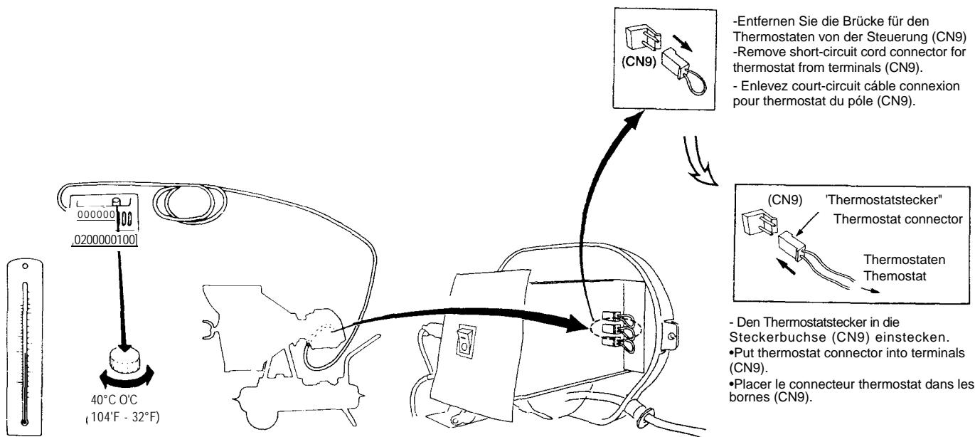
Hinweis: Vor dem Anschließen sind die Thermostatkabel aus dem Thermostatstecker zu entfernen. Setzen Sie die Thermostatkabel in die Bohrung (Durchmesser 9,5) am Gehäuseende ein. Danach setzen Sie die Thermostatkabel wieder in den Thermostatstecker ein.
