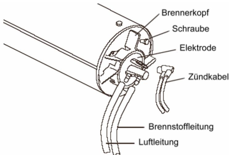
Zünderknoten mit Halterung durch Lösen der Schraube entfernen.
