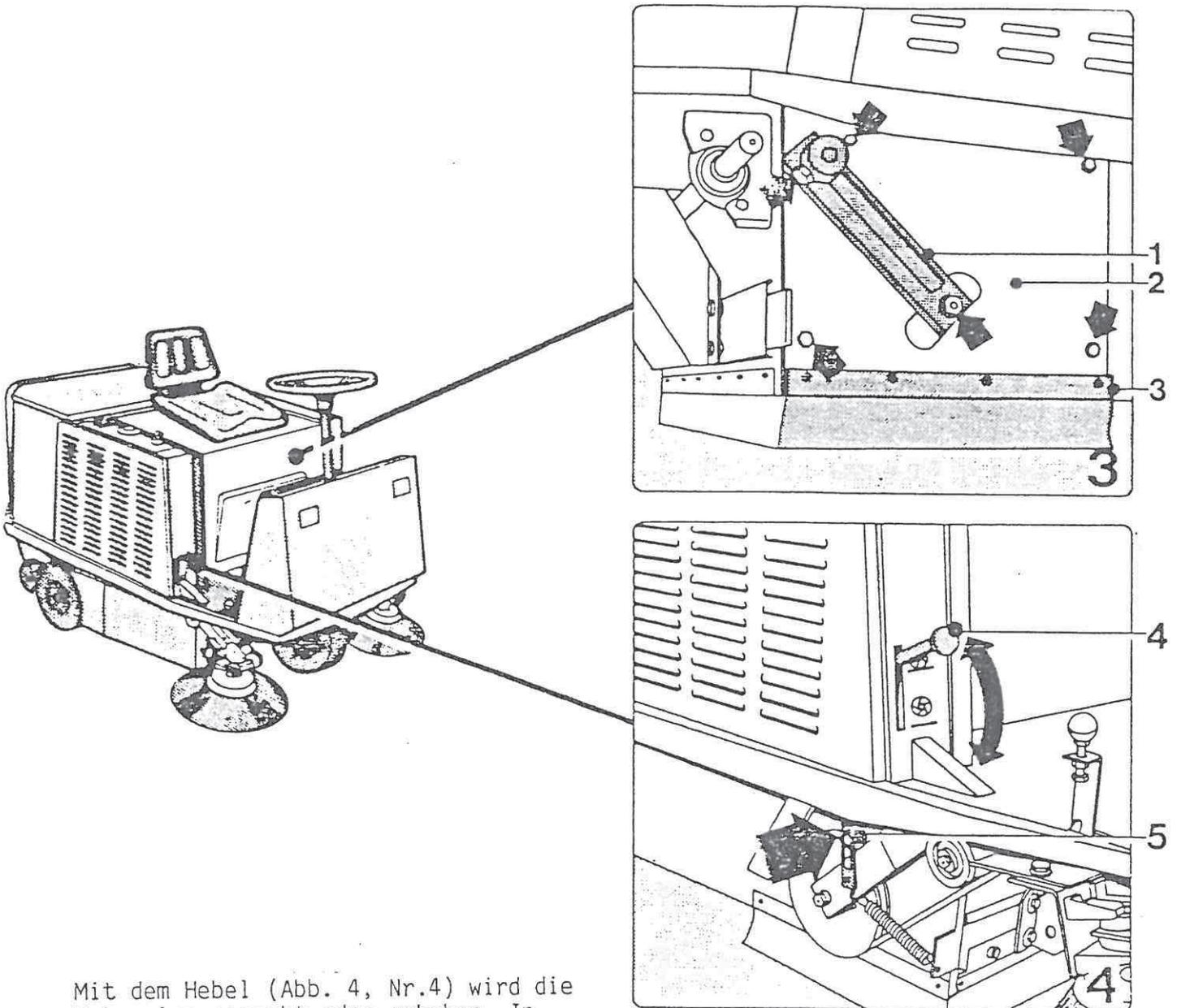
Mit dem Hebel (Abb. 4, Nr.4) wird die Kehrwalze gesenkt oder gehoben. In der obersten Position ist die Kehrwalze gesenkt; in der unteren Position gehoben.
