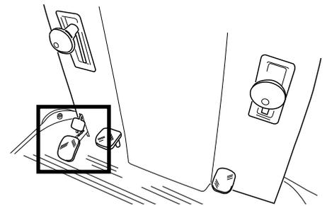
Entleeren des Kehrgutbehälters, Modell 1280, mit Hochentleerung:
