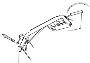
Prüfen, dass sich kein Kehrgut um die Seitenbesen und die Hauptkehrwalze gewickelt hat und ggf. entfernen.
