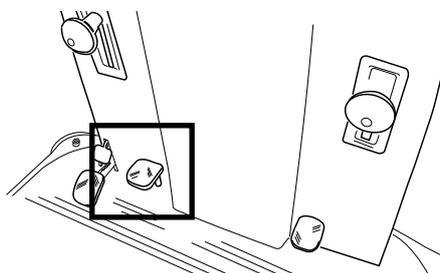
Um die Maschine zu stoppen, das Bremspedal drücken, das auch als Feststellbremse dient und die Maschine entsprechend blockiert.
