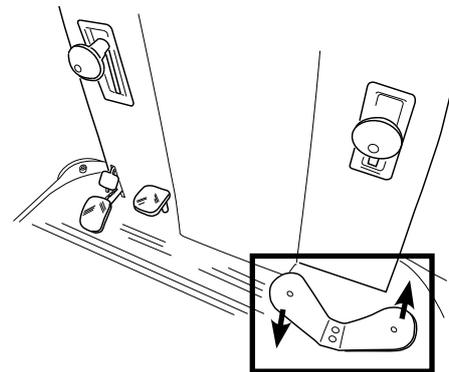
Um sperriges Kehrgut aufzunehmen, das Pedal der vorderen Grobschmutzklappe drücken.
