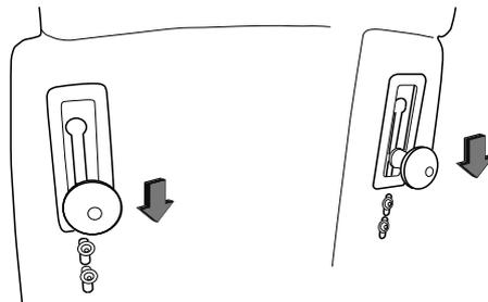
Die Absaugung mit dem Hebel einschalten und den Luftstrom für die Staubabsaugung regeln. Die Absaugung nicht auf nassen Oberflächen verwenden.
