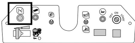
Den Hebel zur Regelung der Motordrehzahl nach rechts auf die höchste Stufe stellen.
