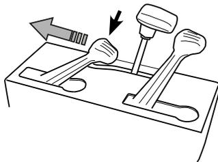
Das Gaspedal betätigen, um mit der Maschine loszufahren. Wird das Pedal nach rechts gedrückt, fährt die Maschine vorwärts, wird das Pedal nach links gedrückt, fährt die Maschine rückwärts.
