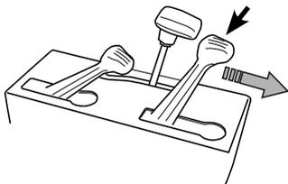
Die Maschine einschalten, indem der Zündschlüssel auf START gestellt wird, bei Start des Motors den Schlüssel wieder loslassen und auf ON zurückstellen sowie den zuvor auf "START" gestellten Hebel loslassen.
