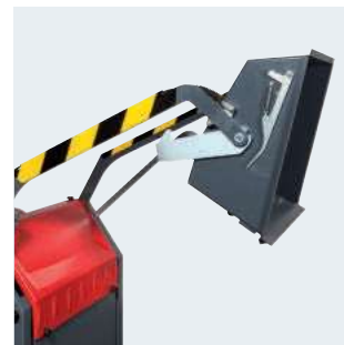
Kippvorrichtung für Entleerung des Schmutzbehälters
