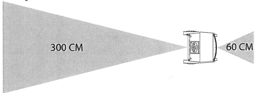
**Optimaler Betrieb** Stellen Sie sicher, dass der zu entfeuchtende Raum geschlossen ist und das Gerät nicht in der Nähe einer Wärmequelle wie z.B. einem Heizkörper aufgestellt ist.
