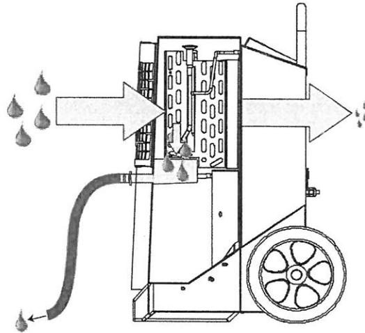
Dadurch, dass die Luft wiederholt durch den Entfeuchter strömt, wird die Luftfeuchtigkeit ständig reduziert. So ist eine schnelle, schonende Trocknung möglich. Der Entfeuchter kann ununterbrochen laufen oder durch einen eingebauten Hygrostaten gesteuert werden.
