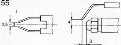
Die Elektroden sind werkseitig eingestellt. Die angegebenen Maße dienen zur Kontrolle.
