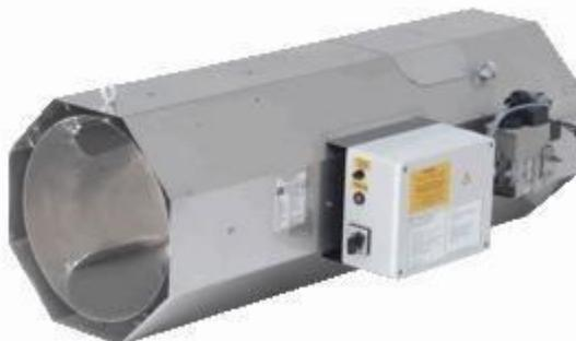
Gasbefeuerter Warmlufterzeuger zur Beheizung von Hallen und Ställen als Vollautomat mit Infrarot-Flammenüberwachung, elektrischer Automatikzündung und unterstützendem Luftgebläse mit offener Brennkammer zum Betrieb ohne Abgasführung
